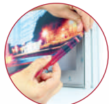
Grafik in den Keder-Kanal einfügen
